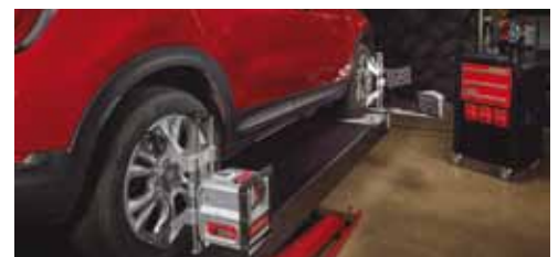
V1200 er et profesjonelt og plassbesparende 3D-hjulstillingsapparat også for de med begrenset plass.
